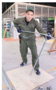
金属管曲げ作業
